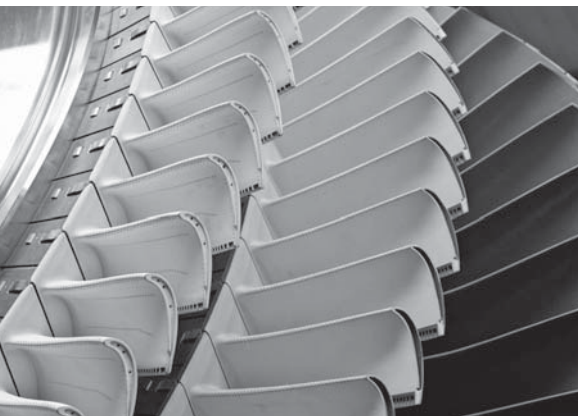
Detailansicht der Turbinenstufen eins bis drei
