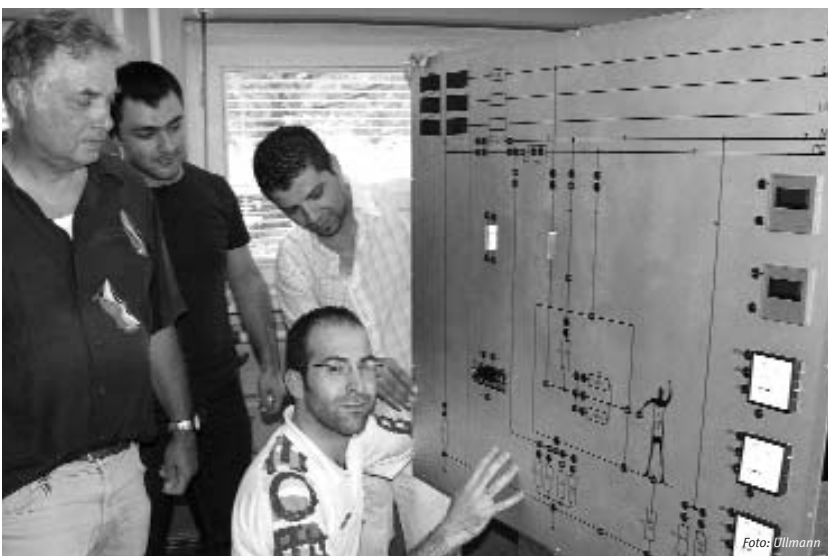
Der Diplomand Abanozoglu Sener (Mitte) – von Prof. Hühns (links) betreut – richtet eine neue »Versuchstafel für Schutzmaßnahmen« nach VDE 0100 ein. Schutzmaßnahmen verhindern bei Störfällen das Entstehen von Berührungsspannungen an leitenden Oberflächen, was für den Menschen tödlich sein könnte.
