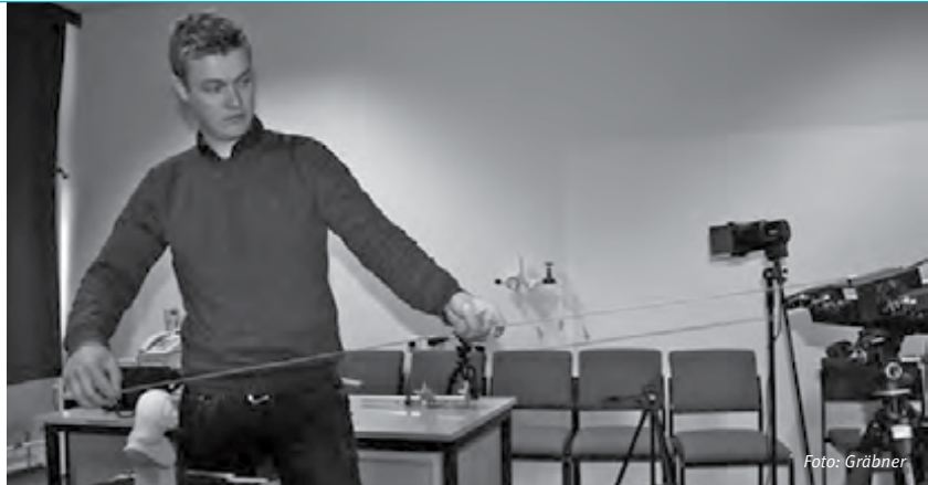
Mit dem Streifenlichtscanner vermisst Martin Floth eine Beuth-Büste: selbst kleine Objekte können mittels 3D-Messtechnik sehr genau erfasst werden.
