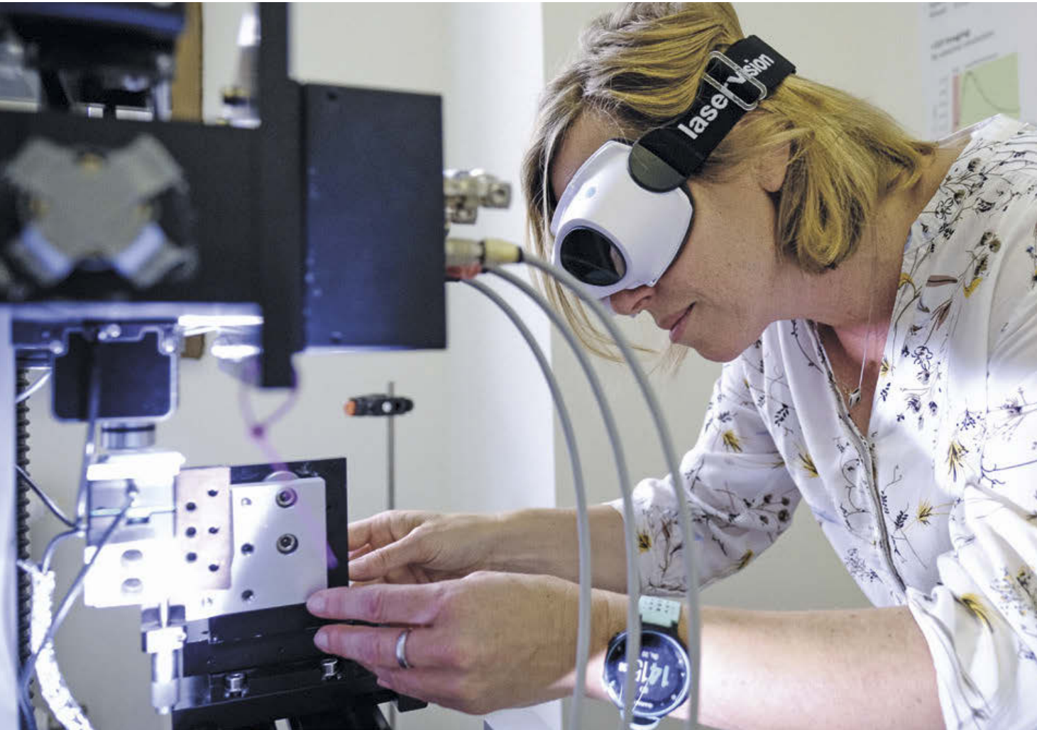
Medizintechnik zwischen Hightech im Labor und Lowtech in abgelegenen Einsatzgebieten. Ingeborg Beckers hier bei der Justierung eines Präparates am 2-Photonen-Mikroskop (am InvertiSCAN, World of Medicine) in ihrem Labor für Optik und Lasertechnik
